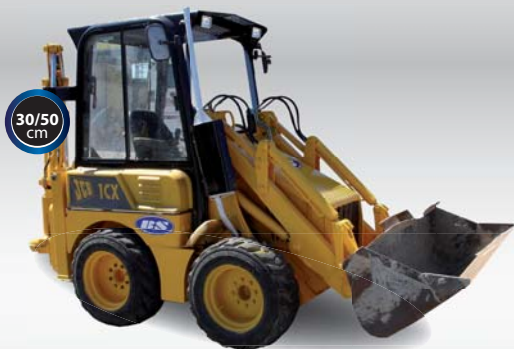
JCB1 (šíře podkopové lžičce - 30, 50cm, vč. paletových vidlí)
