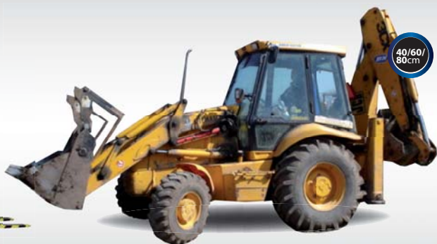
JCB3 TRAKTORBAGR (šíře podkopové lžičce - 30, 40, 60, 80cm, svahová paletové vidle)
