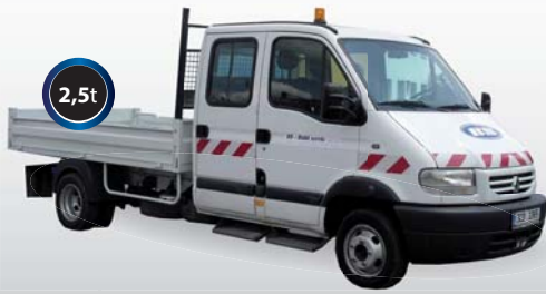
VALNÍK MASCOTT, nosnost 2,5t (sklápěcí korba - 2,75 x 1,9m)
