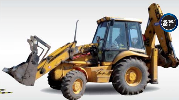
JCB3 TRAKTORBAGR (šíře podkopové lžice - 30, 40, 60, 80cm, svahová paletové vidle)
